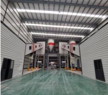
图 1.8 混凝土搅拌站
